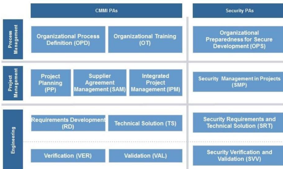
Obrázek 1c - Znázornění vztahů mezi bezpečnostními procesními oblastmi a procesními oblastmi v rámci CMMI-DEV v1.3.[3, s. 15]
